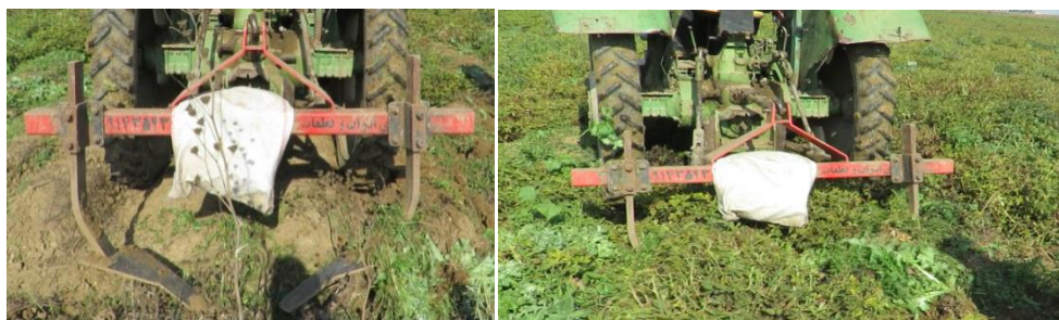
شکل ۲ - تیغه‌های شمشیری مخصوص کندن ریشه بادام‌زمینی در زیر خاک
