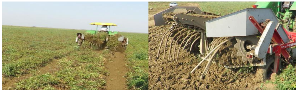
شکل ۴- ماشین کاملاً مکانیزه برای درآوردن و ردیف کردن بوته بادام‌زمینی
