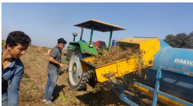
شکل ۵ - برداشت نیمه‌مکانیزه بادام‌زمینی با خرمن‌کوب معمولی و پشت تراکتوری
