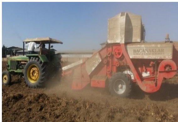
شکل ۶ - برداشت مکانیزه با کمباین کششی مخصوص بادامزمینی
