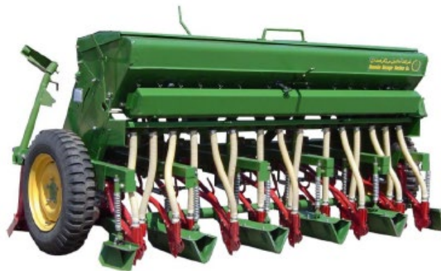
شکل ۳- نمایی از یک دستگاه خطی کار پشته‌کار برای کشت گیاهانی نظیر کلزا روی پشته
